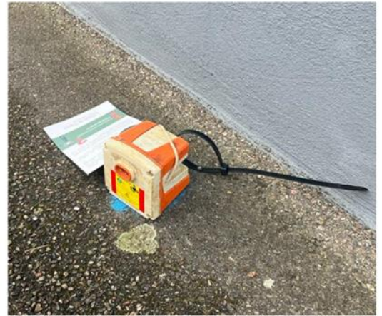
Géophone placé dans différents environnements (largeur ~20 cm) ©S 3
