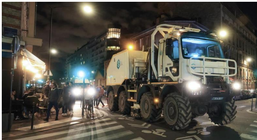
Camion-vibreur Thomas T65 en phase d'acquisition en Ile de France @S 3
