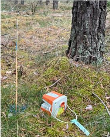
Géophone placé dans différents environnements (largeur ~20 cm) ©S 3
